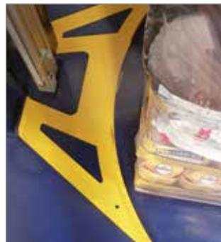
Palettenanschlag für korrekte Positionierung
