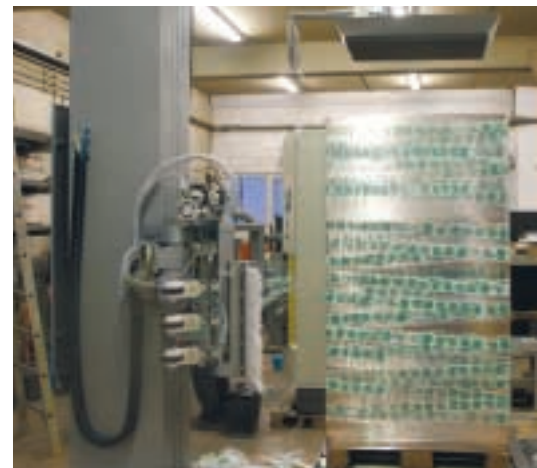
Vollautomatischer Palettenwickler, zur Integration in eine automatische Verpackungslinie
