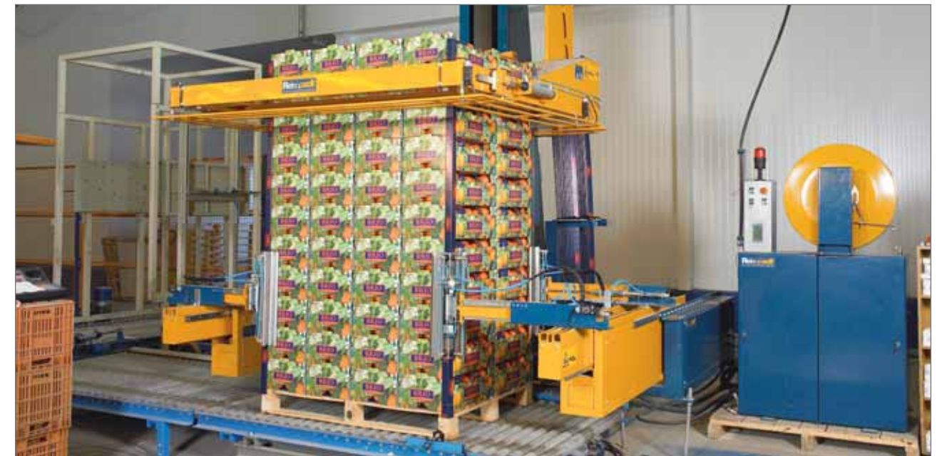
Vollautomatische Umreifungsanlage RP-2901 mit Kantenschutzwinkelanlage
